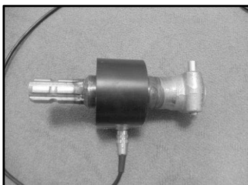
شکل ۳- تورک متر مدل Datum Electronics Torque Log
