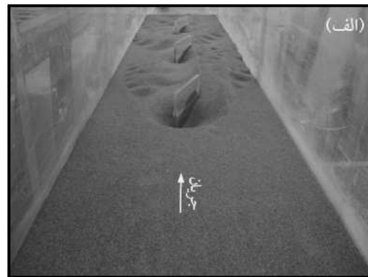
شکل ۴- (الف) توپوگرافی بستر رسوبی پس از زهکشی کامل، صفحه نوع B_1 در U/U_c = 0/78 ؛ و (ب) توپوگرافی بستر رسوبی پس از قطع جریان، صفحه نوع B_5 در U/U_c = 1/19
