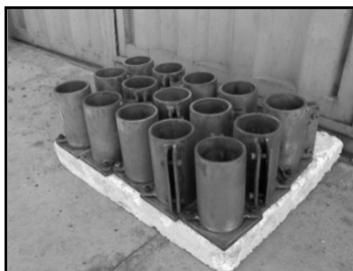
شکل ۳- قالب‌های استوانه‌ای ۱۵۰×۷۵ میلی‌متر
