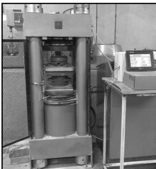
شکل ۴- دستگاه بتن شکن دیجیتال مدل WF55654
