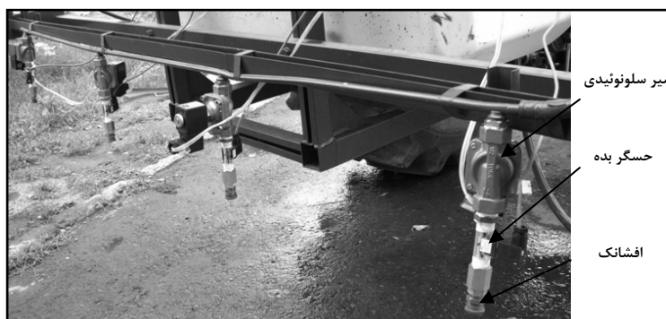
شکل ۳- شیرهای سلونوئیدی و حسگرهای نصب شده روی بوم.
