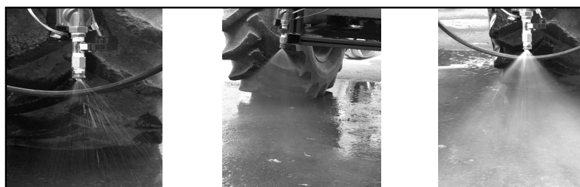
شکل ۶- پاشش افشانکها (از راست به چپ چرخه وظیفه ۵۰، ۳۰، و ۲۰ درصد).
