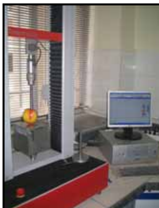
شکل ۳- تعیین ویژگی‌های بافتی میوه شلیل با دستگاه آزمون مواد
