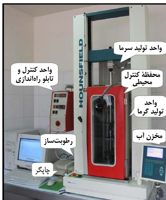
شکل ۳- ماشین آزمون مواد هانسفیلد مدل H50K-s مجهز به محفظه کنترل محیطی
