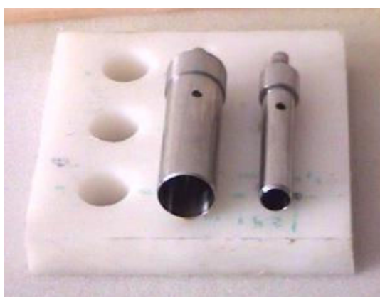
شکل شماره ۳- تصویر ابزار نمونه‌گیر بافت: (الف) نمونه‌گیر استوانه‌ای و صفحه تفلون، (ب) نمونه‌گیر پوست سبز برای آزمون کششی
