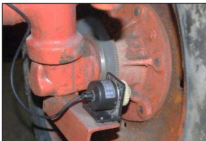
شکل ۲- محل قرارگیری حسگر سرعت پیشروی
