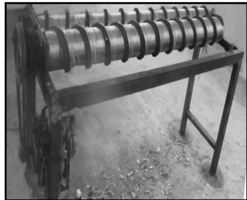
شکل ۱- نحوه اتصال غلتک‌ها روی شاسی اصلی (طول، عرض و ارتفاع شاسی به ترتیب ۱۷۰، ۴۰، و ۸۰ سانتی‌متر است).
