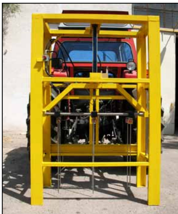
شکل ۵- نفوذسنج مخروطی پشت تراکتوری مجهز به میله‌های نفوذ چندگانه
