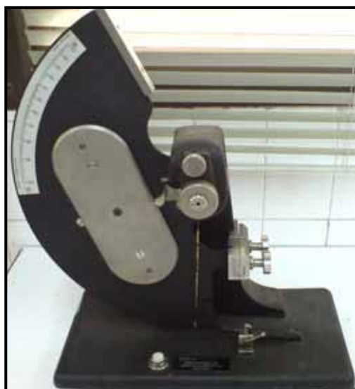
شکل ۲- دستگاه آزمایش مقاومت در برابر رشد پارگی در فیلم
