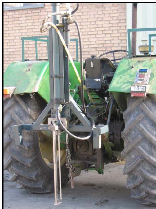
شکل ۱- نفوذسنج پشت تراکتوری ساخته شده
