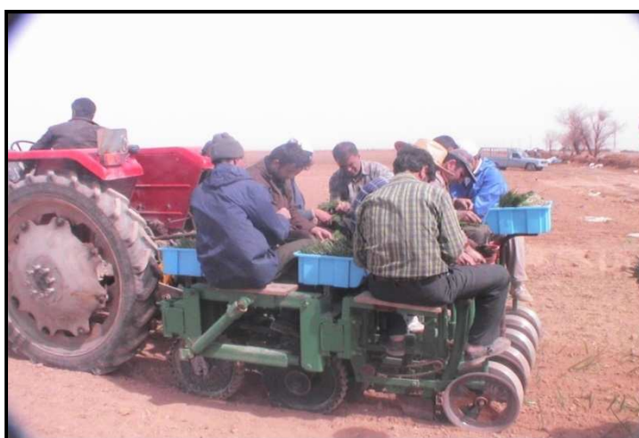
شکل ۱- ماشین نشاکار ۹ ردیفه در حین نشاکاری
