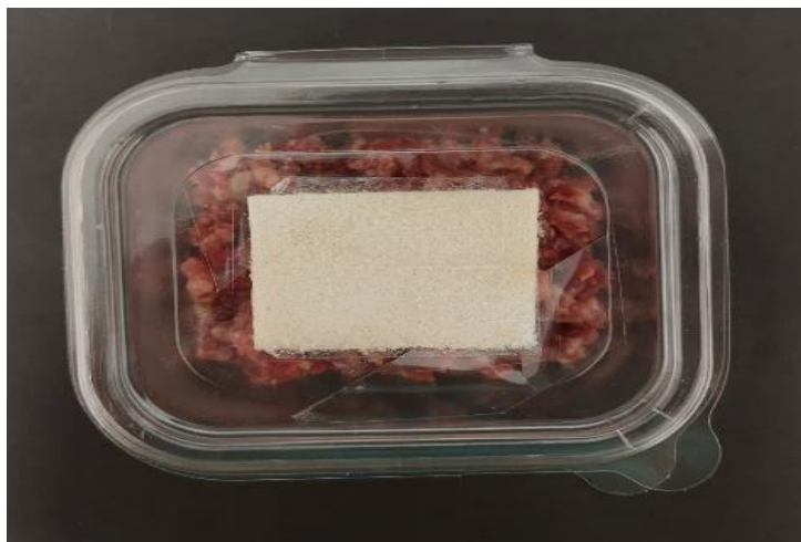
شکل (۱). شکل موقعیت قرار گیری آئروژل ضد میکروبی در بسته‌بندی گوشت چرخ کرده
