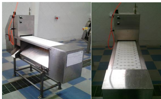
شکل ۱. نماهای روبه‌رو و جانبی دستگاه هسته‌گیر سوزنی- فنجانى
