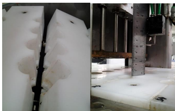
شکل ۲. راست) قرارگیری فنجانکها و سوزن‌ها در موقعیت هسته‌گیری و چپ) مکانیزم باز شدن فنجانکها در انتهای دستگاه. Fig.2. left) the mechanism of opening the cups at the end of the device and Right) placement of the cups and needles in the nucleation position.
