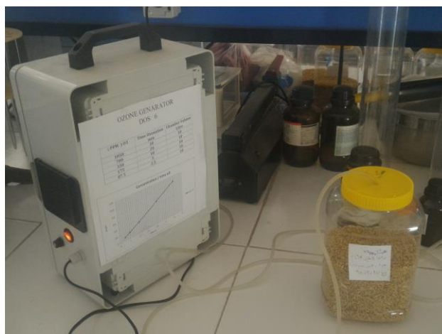
شکل ۱- روش ازن‌دهی نمونه‌های گندم آزمایش
